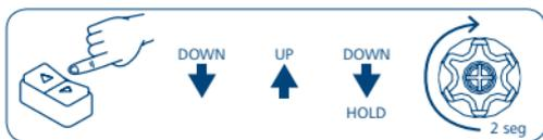
¡Atención! Si la secuencia prevé una repetición de comandos iguales (Up+Up/Down+Down) se necesita interponer la posición Stop si el tipo de inversor lo prevé.
