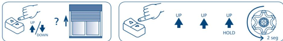
Mediante el pulsador de bajada, llevar dos veces la persiana a la posición de cierre dejando que el motor detecte automáticamente el fin de carrera.
